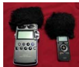
植田使用のレコーダ。左がSony PCM-D1,右がOlympus Voice-Trek DS-750。上部の黒いフワフワしているものが「ウィンドジャマー」。
